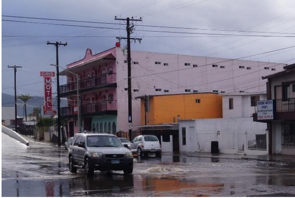
FIGURA 54 DESBORDE DE POZOS DE VISITA POR INTRUSIÓN DE AGUA DE LLUVIA
