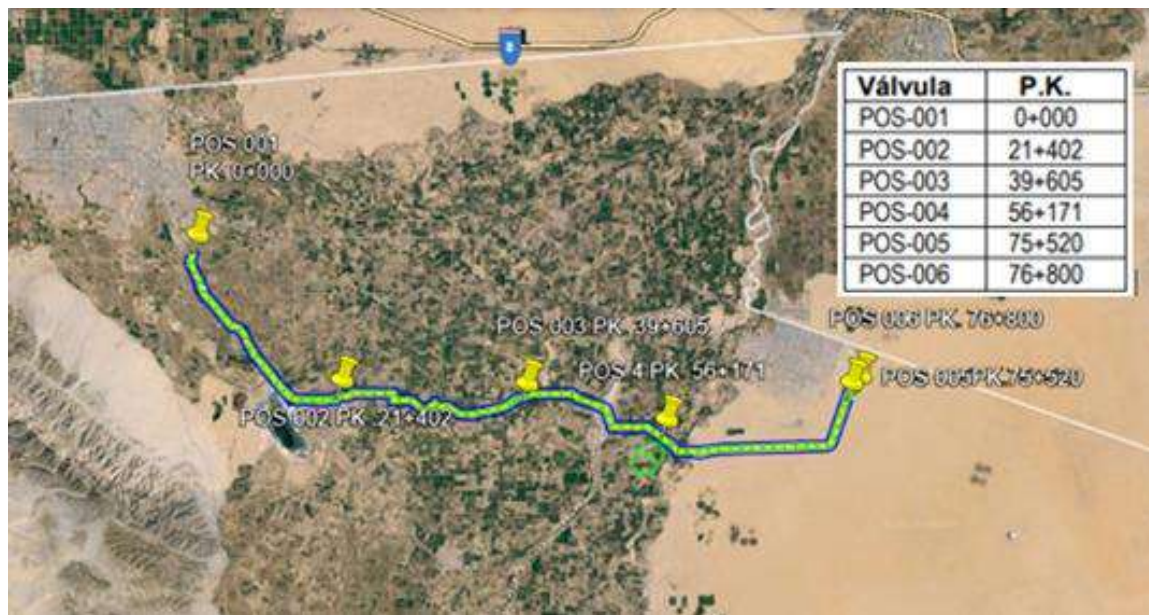
Figura 77. Posiciones de Válvulas de Seccionamiento.
